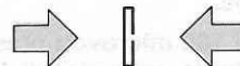
Fig. 32 Come vedesi in tale diagramma, il dipolo presenta l'inconveniente di risultare onnidirezionale, cioè di captare con identica intensità tutti i segnali che giungono frontalmente e posteriormente, cioè anche tutte le onde riflesse.
